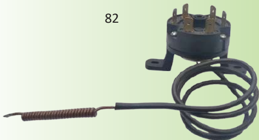
3-poliger Thermostat mit manueller Rückstellung, hoher Grenzwert, ausfallsicher, feste Einstellung, Temperaturbereich bis 170°C
